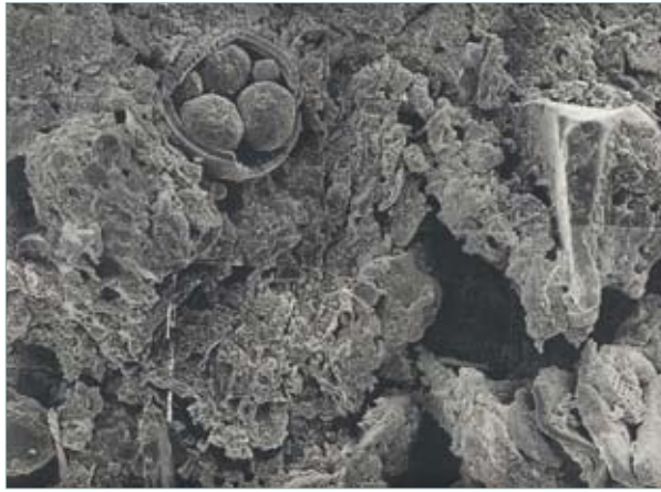
有明粘土のミクロ分析 (SEM 走査型電子顕微鏡)
